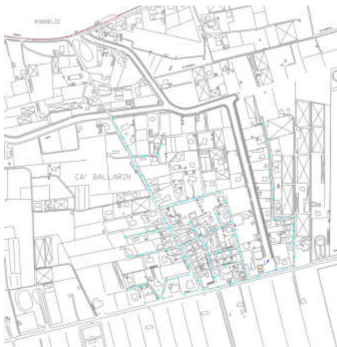
Figura 8-13: Rete di fognatura acque bianche e miste in località Ca' Ballarin (stralcio Planimetria rete acque bianche e miste di Veritas, 2012)
