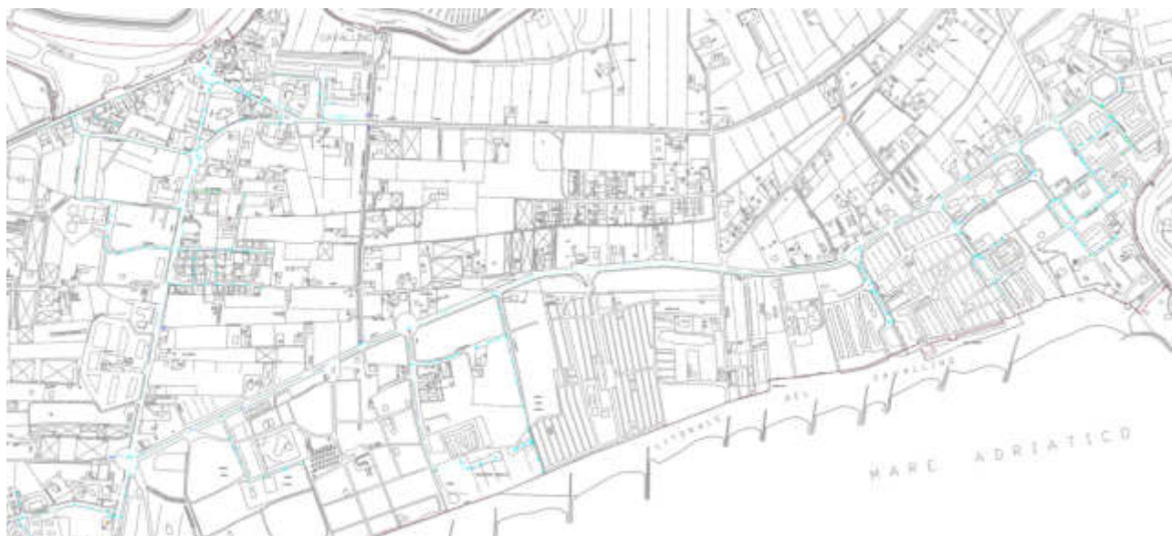
Figura 8-15: Rete di fognatura acque bianche e miste in località Cavallino (stralcio Planimetria rete acque bianche e miste di Veritas, 2012)
