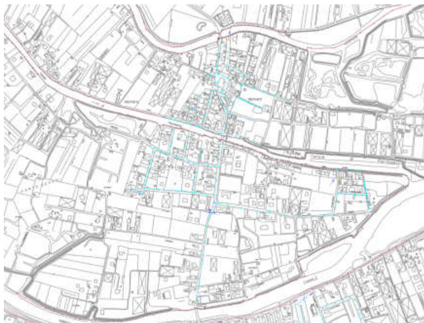
Figura 8-11: Rete di fognatura acque bianche e miste in località Portosecco e Treporti (stralcio Planimetria rete acque bianche e miste di Veritas, 2012)
