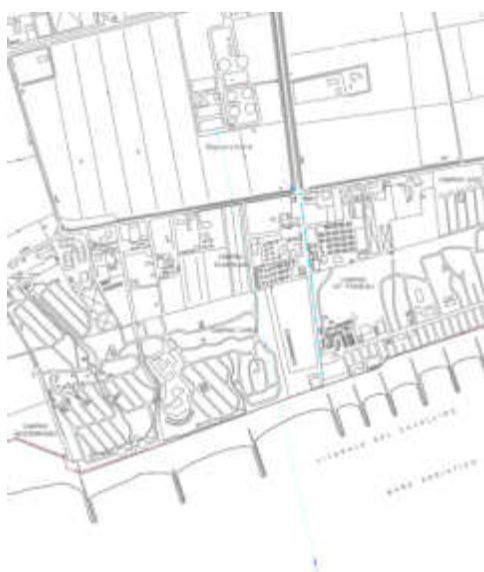
Figura 8-12: Rete di fognatura acque bianche e miste in località Ca' Pasquali (stralcio Planimetria rete acque bianche e miste di Veritas, 2012)
